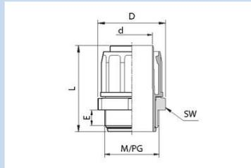
**Kunststoff-Schlauchverschraubung mit integrierter Innentülle; drehbares Anschlussgewinde**
